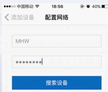
4. 手机APP搜索到设备并配置空气管家，完成后见右图，输入自定义的名称，如“卧室”；输入4位设备密码，如“1234”（输入密码用于保护隐私），点击保存。
